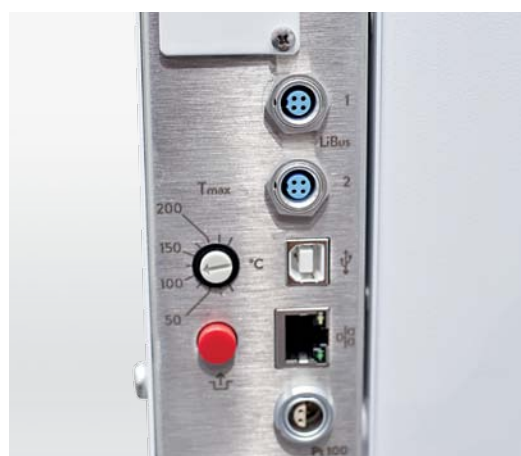
Interfaces Ethernet et USB et raccord Pt100
